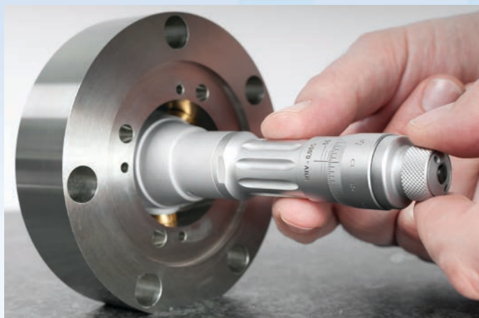
Měření uskutečněno s přístrojem IMICRO 40 ÷ 50, obj. číslo 00812301
