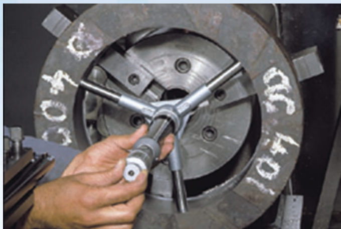
Měření uskutečněno s přístrojem IMICRO 90 ÷ 100, obj. číslo 00812306
