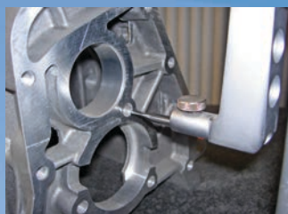
Měření otvorů v klikové skříni motoru pomocí přístroje MICRO-HITE 600.
