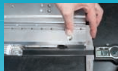
Měření hloubky otvoru
