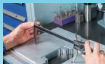
Měření osové vzdálenosti posuvným měřítkem se špičkami pro vnější měření
