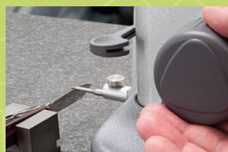
Měření nejvyššího bodu tvořeného průsečíkem rovin
