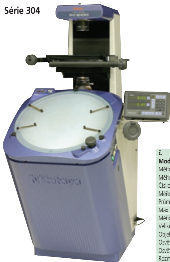
č. 304-909 D (PV-5110) s KA-Counter (standardní příslušenství)
