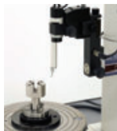
Systém měření drsnosti pro RA-2100 CNC (zvláštní příslušenství)
