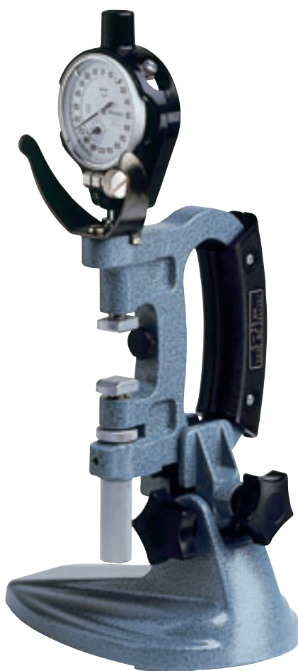
201-101 s držákem 156-101 a úchylkoměrem s ochranou
