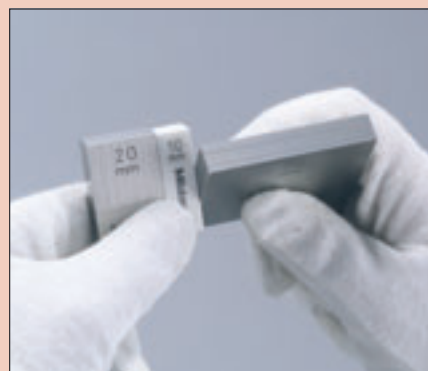
Příklad použití Příložený ocelové a koncové měrky.
