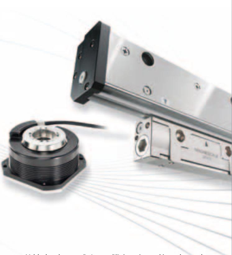
Vzhledem k tomu, že jsou měřicí systémy celé vyrobeny z kovu, mají stejné tepelné vlastnosti jako stroj samotný. Teplotní rozdíly tak mají na přesnost obráběcího stroje jen zanedbatelný vliv. Nová řada zahrnuje absolutní délkové měřicí systémy až do 3640 mm a absolutní úhlové snímače s vnitřním průměrem hřídele 20 mm, 96 mm nebo 180 mm.
